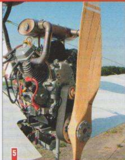
5- Briggs & Stratton Vanguard 630 cc 2 Zylinder Viertakt V-Motor mit 30 PS 6- Federtrimmung Höhenruder: Einfach, wirkungsvoll, robust.
