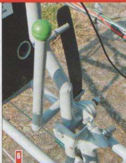
5- Briggs & Stratton Vanguard 630 cc 2 Zylinder Viertakt V-Motor mit 30 PS 6- Federtrimmung Höhenruder: Einfach, wirkungsvoll, robust.
